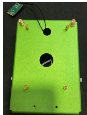
תמונה 4. תושבות מורכבות על בסיס הרובוט
