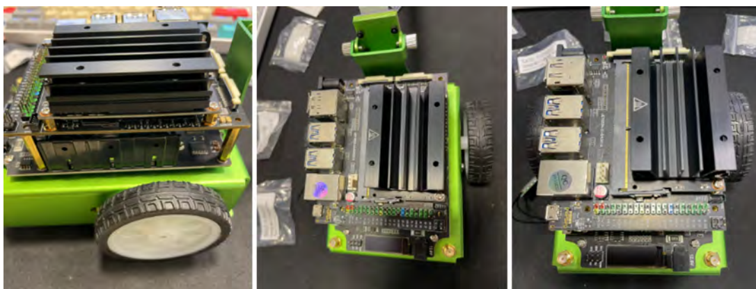
תמונה 15. הרכבת כרטיס ה-Jetson לגוף הרובוט
