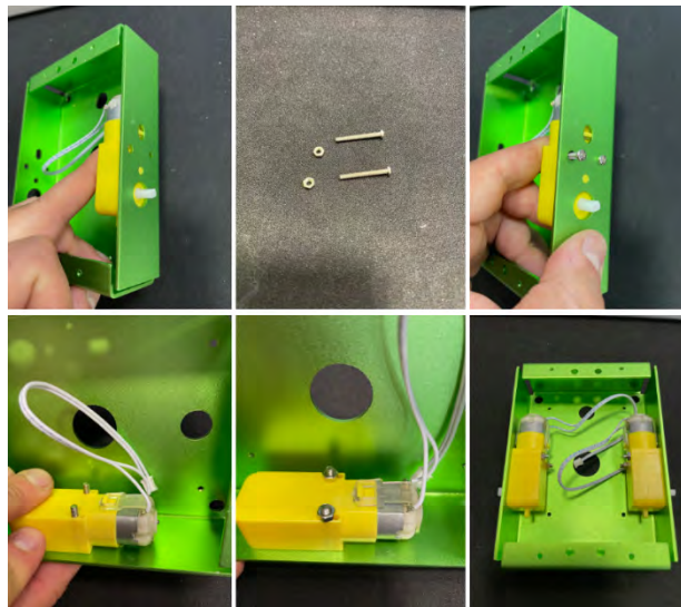
תמונה 2. הרכבת המנועים למסגרת
