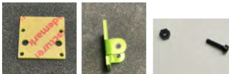
תמונה 6. לוח מצלמה, מתקן המצלמה ובורגי החיבור
