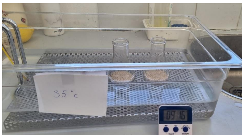
תמונה 6.1: אינקובציה של השמרים המקובעים באמבט בטמפרטורה של 35°C
