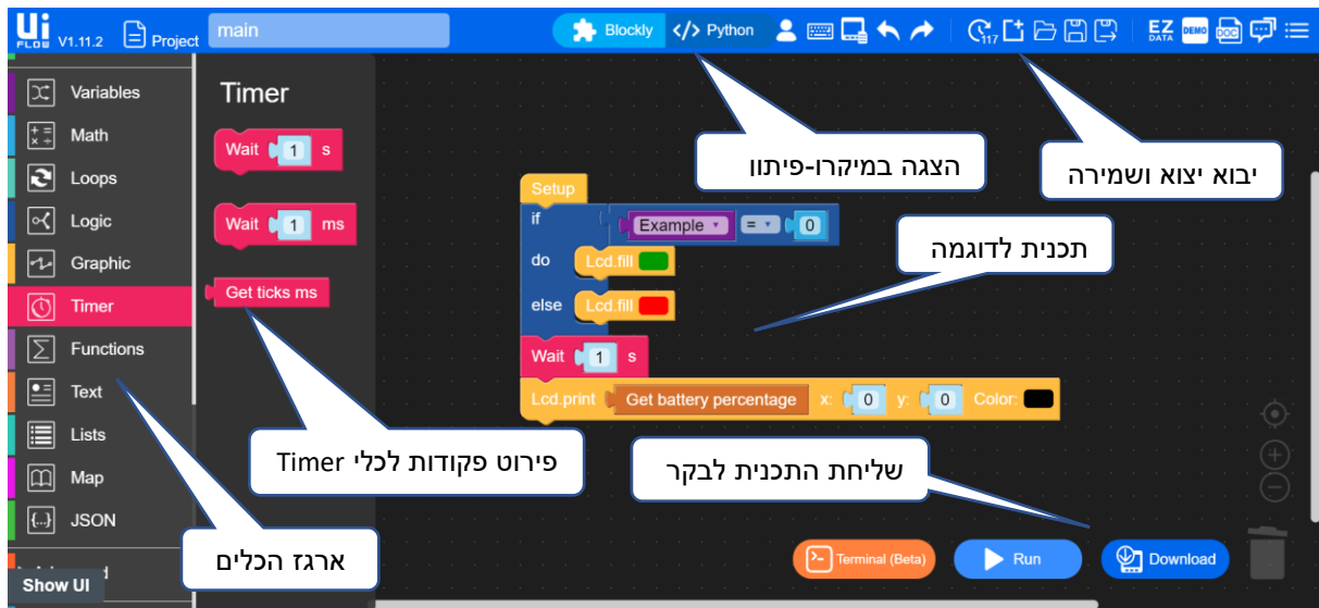
איור 4.1: ממשק המשתמש של תכנת UIFlow לבקרי M5 המבוססת על בלוקלי
